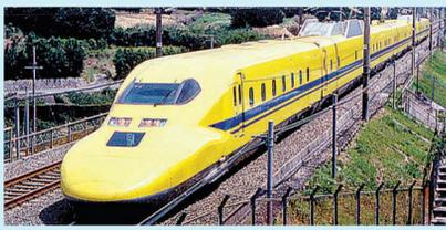
ドクターイエローの正式名称は「新幹線電気軌道総合試験車」で、線路や架線の状態などを走りながら検査します。JR東海とJR西が1編成ずつ所有し、10日に1回程度、東京一博多間を走行しています。
